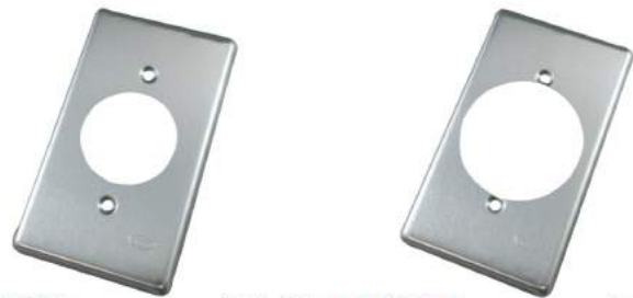
LK9641 (10入/盒) 單聯白鐵蓋板 電木 30A & 4P20A引掛暗插座用 直徑:41.5 mm LK9651 (10入/盒) 單聯白鐵蓋板 接地30A暗插座用 直徑:54mm
