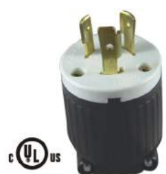
UL US LK-6322 美規引掛式插頭 L6-20P 20A250V (2P3W)
